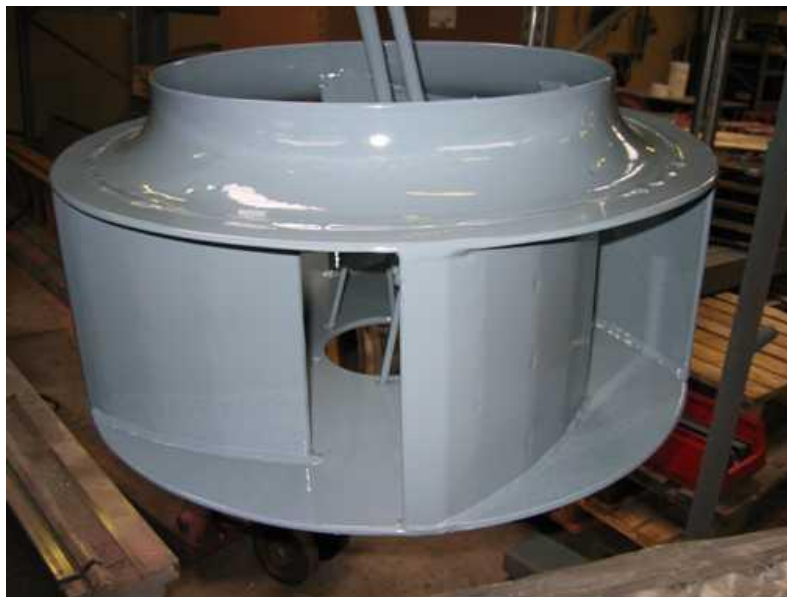
Test af ventilator med/ uden coating
